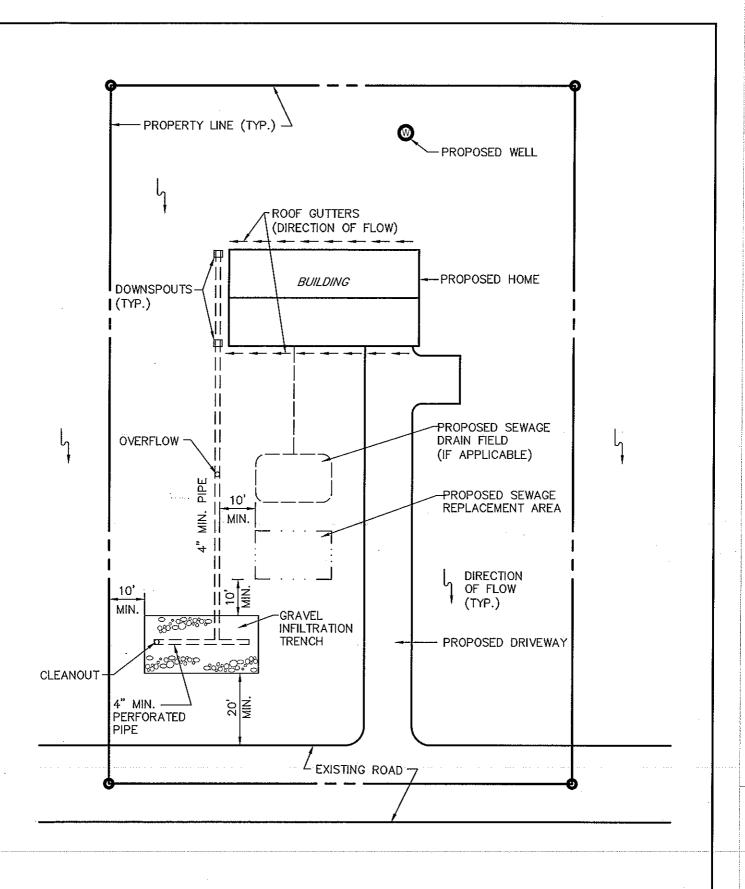
EXHIBIT A TYPICAL INFILTRATION TRENCH PLAN
